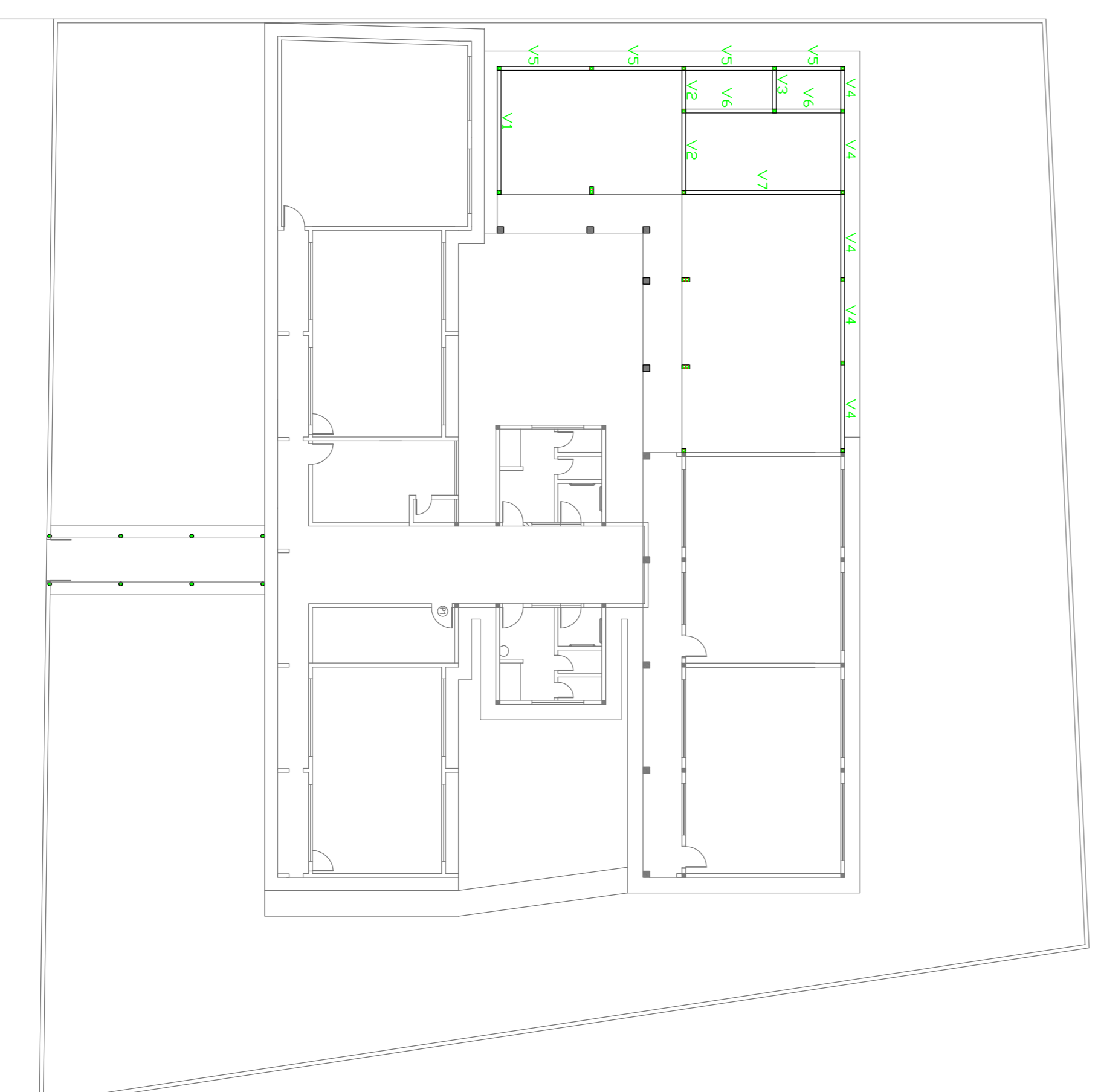
PLANTA DE LOCAÇÃO DE VIGAS SUPERIORES ESCALA: 1/175
