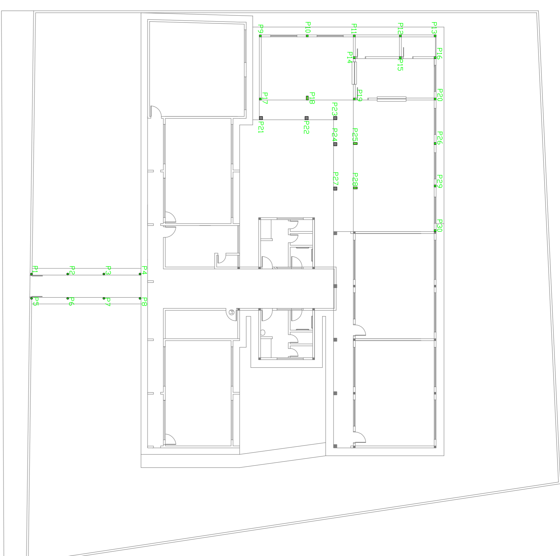
PLANTA DE LOCAÇÃO DE PILARES ESCALA: 1/175
