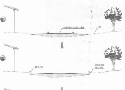
AS OBRAS DE TERRAPLENAGEM, DE DRENAGEM DE REGULARIZAÇÃO E ESTABILIZAÇÃO DA CAMADA QUE SERVIRÁ DE BASE DO CALÇAMENTO (GERALMENTE UMA CAMADA DE SOLO OBEDECENDO AS ESPECIFICAÇÕES DE SUB-BASE, DERT-ES-P 03/00) OU RECONFORMAÇÃO DA PLATAFORMA DEVERÃO ESTAR CONCLUÍCAS
