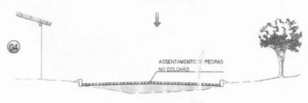
OS BLOCOS DE PEDRA TOSCAS SERÃO ASSENTES SOBRE O COLCIÃO DE ARBIA EM LINHAS PERPENDICULARES AO EIXO DA PISTA, OBEDECENDO AS COTAS E ABAULAMENTOS DO PROJETO, EM TANGENTE, O ABAULAMENTO SERÁ FEITO POR DUAS RAMPAS, OPOSTAS A PARTIR DO EIXO, COM DEGLINIDADE DE 2% SALVO OUTRA INDICAÇÃO DO PROJETO. NAS CURVAS, A DECLIVIDADE TRANSVERSAL SERÁ A INDICADA PELA SUPER-ELEVAÇÃO PROJETADA.
