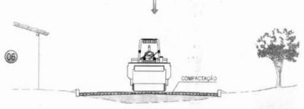
AS PEDRAS SOB A CAMADA DE AREIA DEVEM SER BATIDAS INICIALMENTE COM COMPACTADOR MANUAL TIPO PLACA VIBRATÓRIA E EM SEGUIDA PASSA-SE O ROLO COMPRESSOR. COMEÇANDO PELO PONTO DE MENOR COTA PARA O DE MAIOR COTA NA SEÇÃO TRANSVERSAL.
