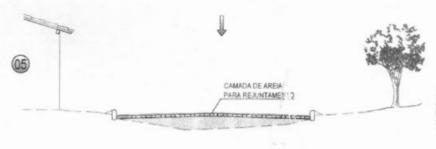
ANTES DA COMPRESSÃO COM O ROLO METÁLICO, JOGA-SE AREIA SOBRE O CALÇAMENTO, NA QUANTIDADE SUFICIENTE PARA PREENCHER AS JUNTAS E FORMAR UMA CAMADA SOBRE O CALÇAMENTO DE APROXIMADAMENTE 2CM.
